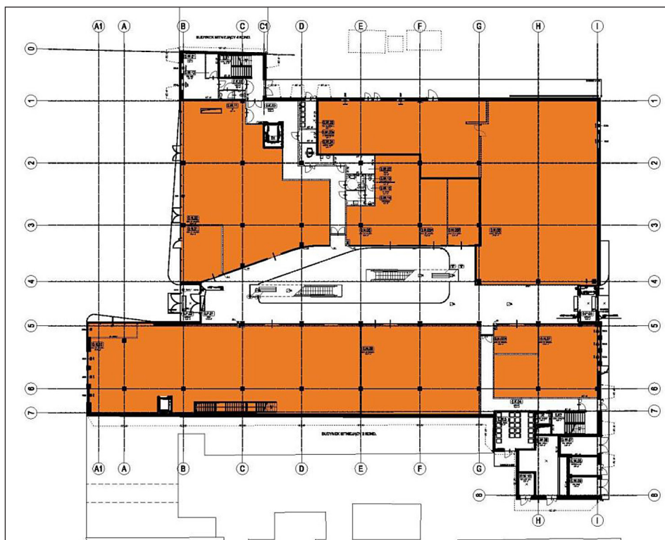
Rys. 1. Stosunek powierzchni najmu (kolor pomarańczowy) do powierzchni całkowitej kondygnacji parteru [Kmieciak, Szymczak 2012]
