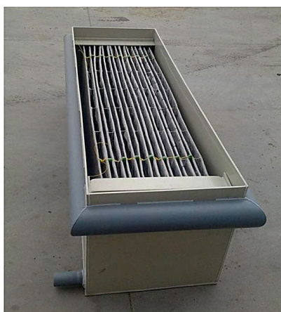
Rys. 1. Filtr włókninowy, z lewej – model badawczy [Haba RL 2015], z prawej – rysunek poglądowy lokalizacji filtra włókninowego (model wykonany przez firmę Haba R.L.): 1 – wlot do osadnika gnilnego, 2 – pompa dozująca ścieki do filtra włókninowego, 3 – wlot do filtra włókninowego, 4 – filtr włókninowy, 5 – wylot z filtra włókninowego, 6 – wylot z osadnika gnilnego, 7 – króćce do odprowadzania osadu
