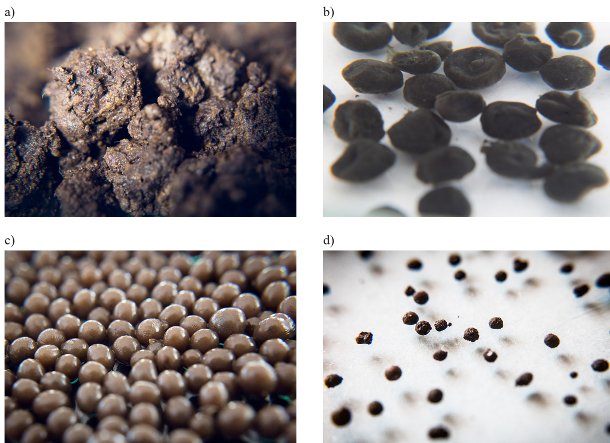
Rys. 4. Kapsulacja osadów ściekowych przy zmiennym stężeniu alginianu sodu: a) surowy osad ściekowy, b) 0,5% roztwór alginianu sodu, c) 2% roztwór alginianu sodu, d) wysuszone kapsułki osadów ściekowych Fig. 4. The sewage sludge capsulation with a variable sodium alginate concentration: a) sewage sludge, b) 0,5% sodium alginate solution, c) 2% sodium alginate solution, d) dried sewage sludge capsules
