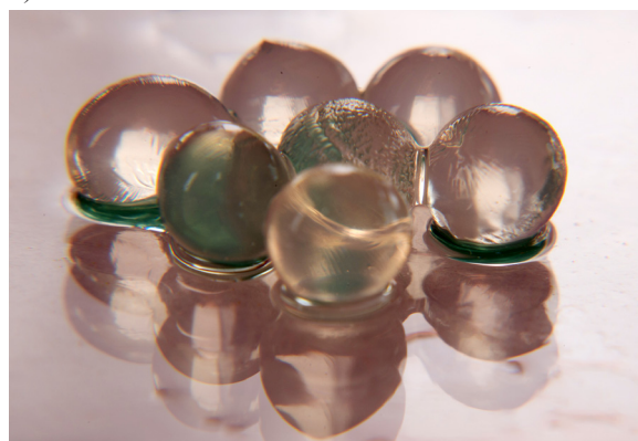
Rys. 2. Kształt kapsułek żelowych w zależności od stężenia alginianu sodu: a) 0,5%, b) 2% Fig. 2. The influence of sodium alginate concentration on the shape of capsules: a) 0,5%, b) 2%
