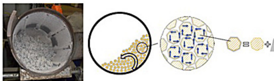
Rys. 2. Bęben obrotowy służący do autogenicznego ścierania kruszywa recyklingowego [Pepe i in. 2014]
