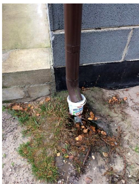
Rys. 1. Miejsca poboru próbek wód opadowych: po lewej pobór spływu z dachu, po prawej opadu bezpośredniego Fig. 1. Stormwater sampling points: on the left collection of roof runoff, on the right direct rainfall collection
