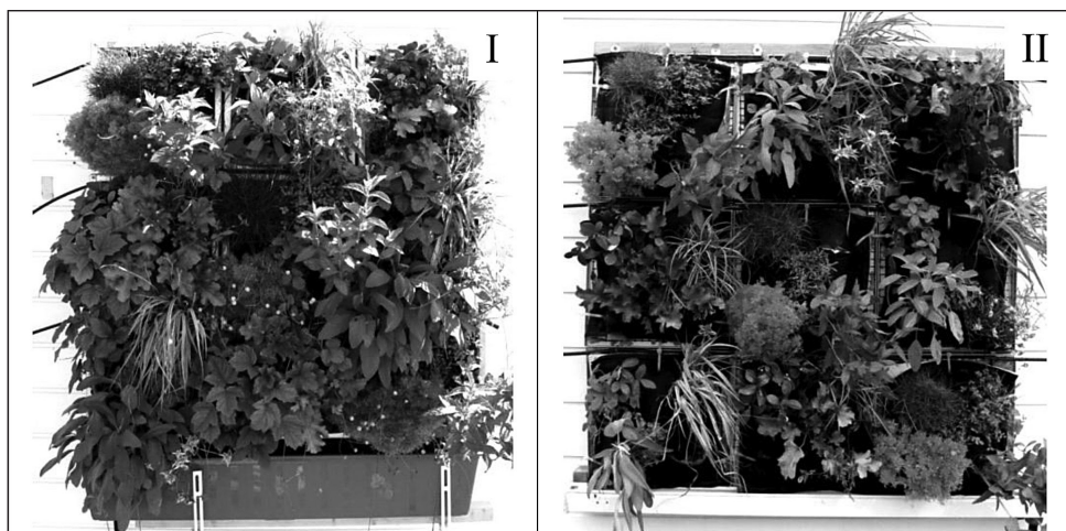
Fot. 2. Rozwój roślin na modelach doświadczalnych zielonych ścian po dwóch sezonach wegetacyjnych; model retencyjny (I) – pokrycie 90%, sierpień 2012 (znaczny przyrost biomasy) oraz model ekonomiczny (II) – pokrycie 60%, sierpień 2012 (znikomy wzrost roślin)
