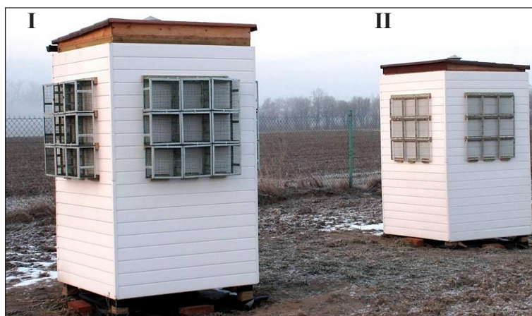
Fot. 1. Modele doświadczalne modułowych zielonych ścian (model retencyjny I, model ekonomiczny II)
