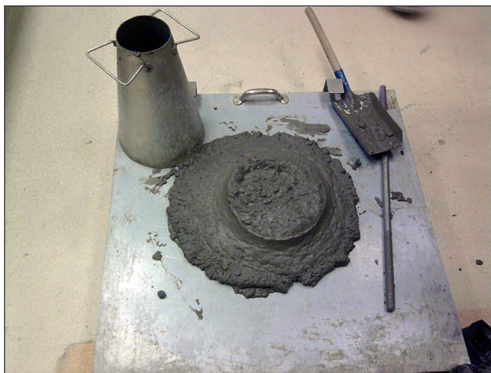
Fot. 1. Badanie konsystencji metodą stożka opadowego
