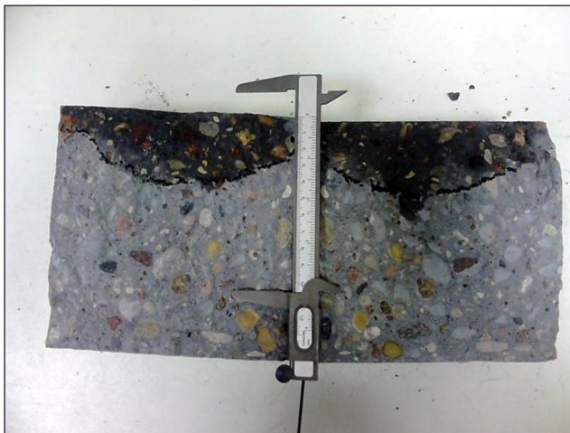
Fot. 2. Poziom penetracji wody po 28 dniach w próbkach betonowych bez dodatków
