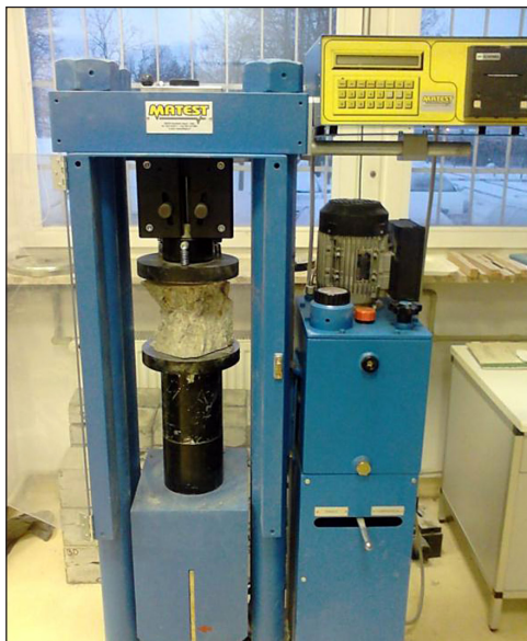
Fot. 3. Badanie wytrzymałości próbek na ściskanie w maszynie wytrzymałościowej
