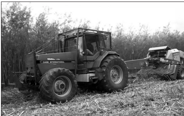
Fot. 3. Zbiór wierzby z użyciem Biobalera, koszenie, balotowanie Picture 3. Willow collection with Bioballer, cutting, ballotement
