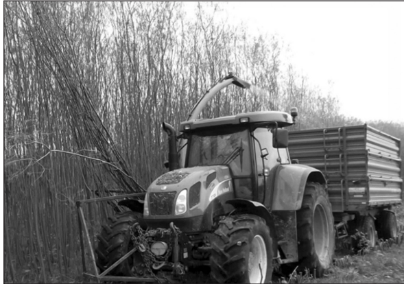
Fot. 1. Zbiór wierzby z użyciem sieczkarni Class, koszenie, zrębkowanie Picture 1. Willow collection with Class straw-cutter
