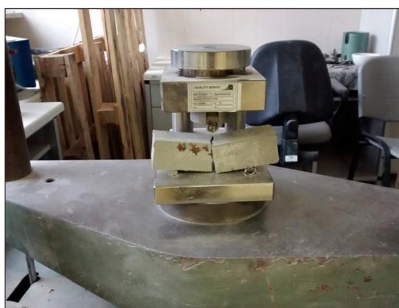
Rys. 3. Zniszczenie próbki podczas badania wytrzymałości na zginanie
