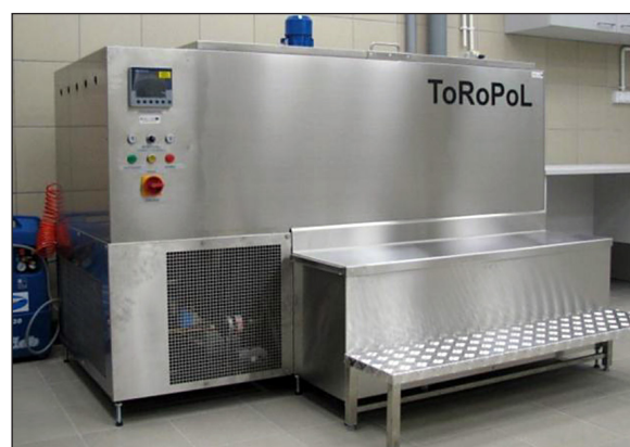
Rys. 7. Komora do badania mrozoodporności betonu Fig. 7. Chamber for concrete freeze resistance tests
