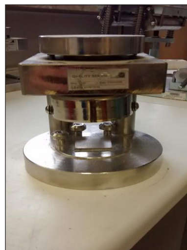
Rys. 5. Aparat do wykonania badań na ściskanie Fig. 5. Apparatus for compression tests
