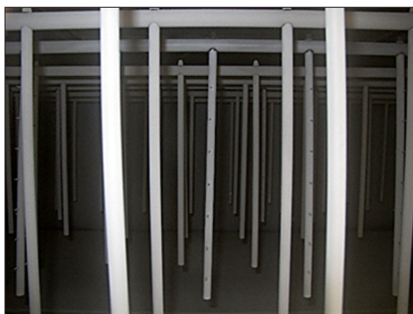
Rys. 3. Widok elektrod aglomeratora/elektryzatora (elektrody pokryte popiołem lotnym) Fig. 3. The set of electrodes of precharger/agglomerator (Electrodes covered with fly ash)
