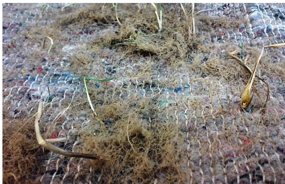
Rys. 7. System korzeniowy trawy w biowłókninie przykrytej warstwą ziemi
