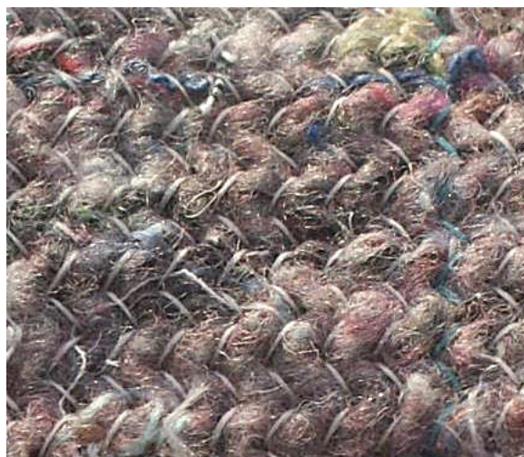
Rys. 1. Biowłóknina AmGreen® Fig. 1. Bio nonwovens AmGreen®
