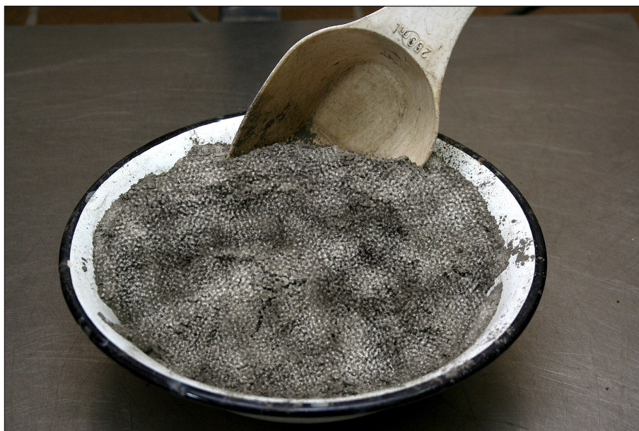
Rys. 2. Bentonit użyty do badań Fig. 2. Bentonite used in the tests
