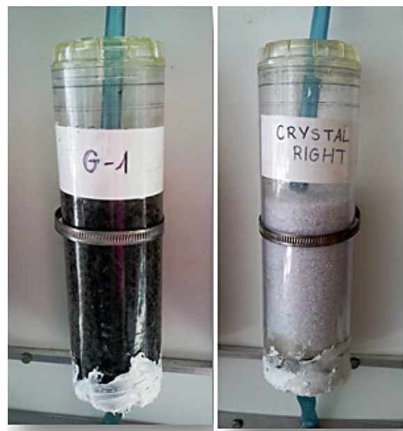
Rys. 3. Kolumny filtracyjne Fig. 3. Filter columns
